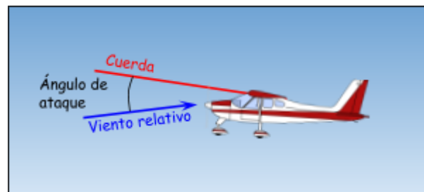
Figura B. El ángulo de ataque (AoA) es el ángulo formado por la cuerda del perfil y el viento relativo.
