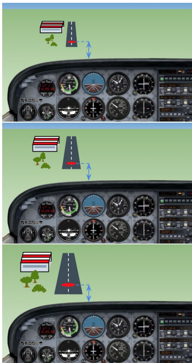
Figura A. Durante una aproximación estabilizada siempre habrá un punto en la pista que aparece estacionario. Ese es el punto al que se dirige el avión.
