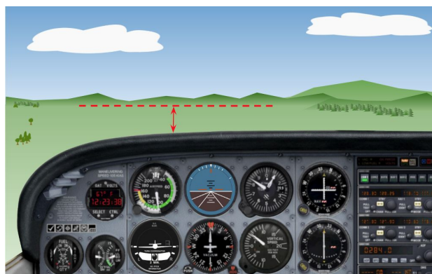
Figura D. La línea horizonte en nuestro campo de visión es la mejor referencia para mantener en todo momento unos parámetros de vuelo adecuados.
