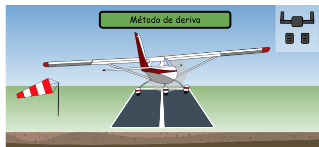
Figura A. En este método aplicamos un ángulo de deriva orientando el morro al viento, con mandos neutros y alas niveladas, para mantener el eje de la pista.
